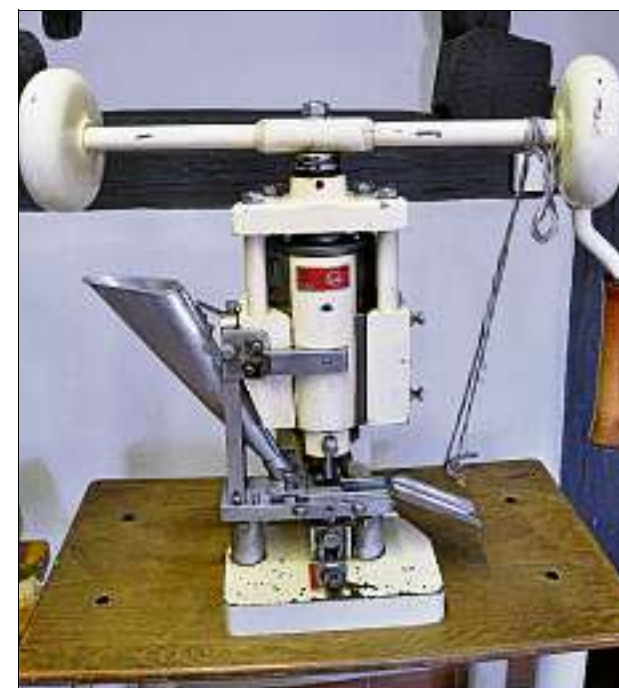
Mit dieser in Leipzig hergestellten Maschine von 1957 pressen die Apotheker in früheren Zeiten Tabletten. Die Rohmasse wurde links in den Trichter gefüllt.
